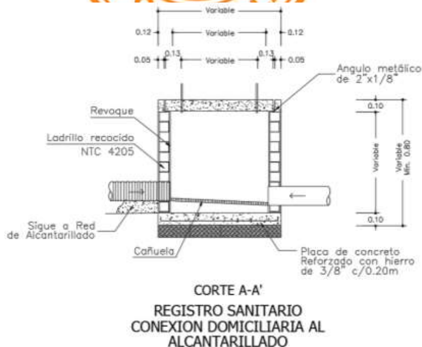
Ilustración 16 Caja De Inspección
