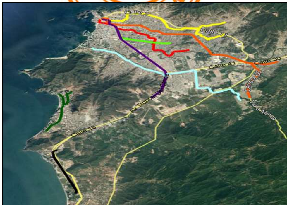
Ilustración 3. Colectores Principales En La Ciudad De Santa Marta * Colector Norte *Colector Libertador * Colector Centro * Colector Cundí * Colector Ferrocarril * Colector La 30 *Colector Tamacá *Colector Zuca.
